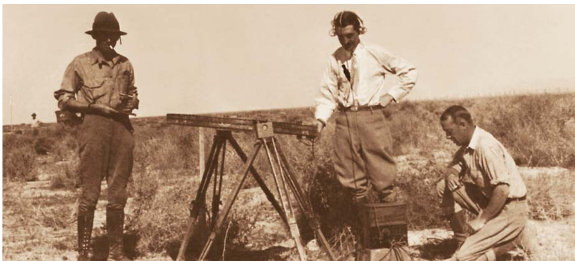
▲ Henri Doll (con auriculares), Allegrete y Gallois prueban un método electromagnético para determinar la inclinación de los sedimentos antiguos que subyacen formaciones más jóvenes. Valle de San Joaquín, California, 1928.
