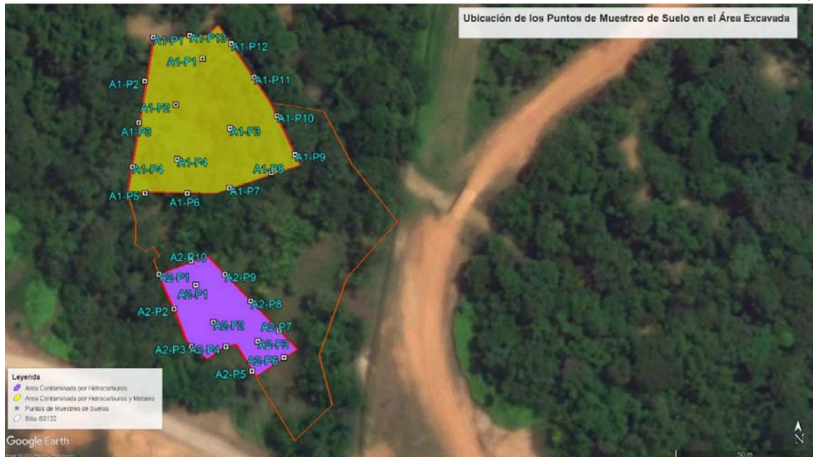
Figura 14 se presenta la ubicación en planta de los puntos de muestreo del área excavada.
