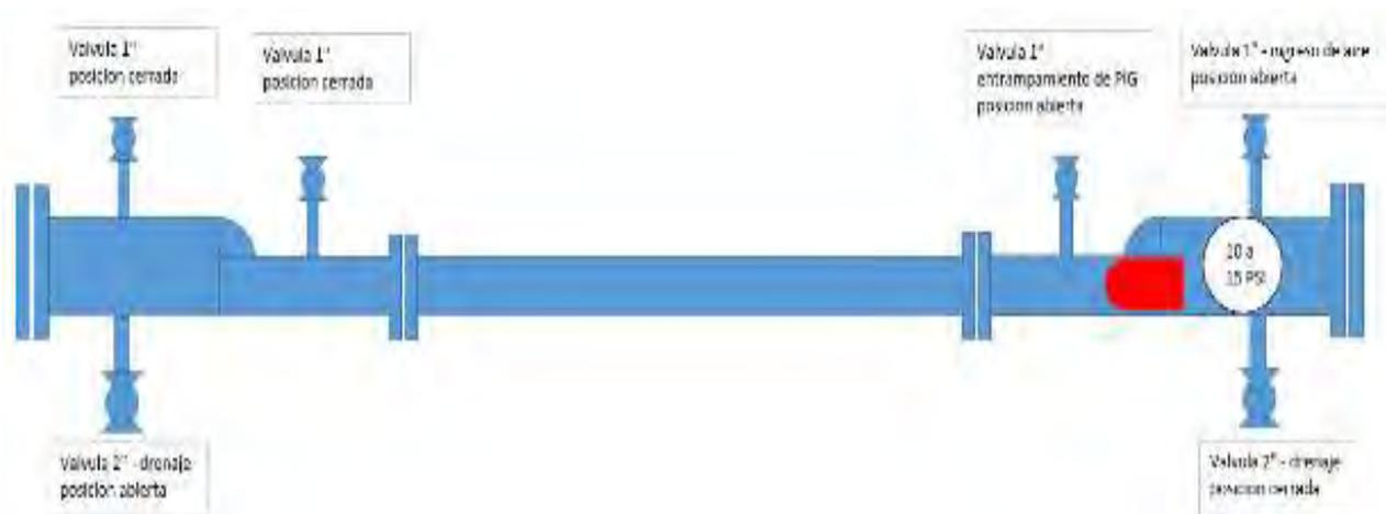
Fig. 2 a – Posición de válvulas durante proceso de
