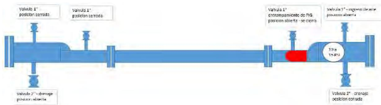
Fig. 2 b – Posición de válvulas al quedar atrapado el PIG
