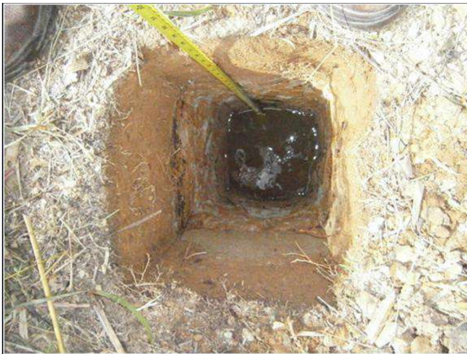
Fotografía 3. Descenso del agua durante el tiempo de duración de la prueba de percolación
