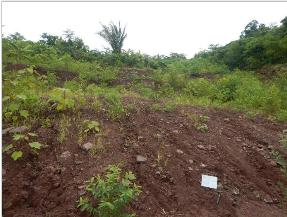
Foto 2. Depósito eluvial con cantos angulosos envueltos en una matriz limo-arcillosa, el cual se encuentra húmedo por las precipitaciones locales, ubicado al este del PAD B
