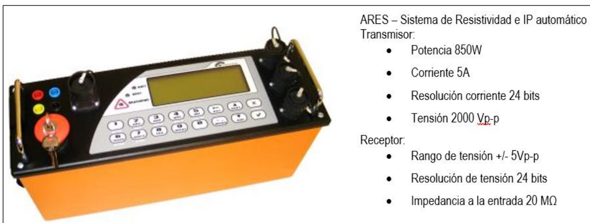
Figura 2 Características del equipo ARES I – GF instruments.
