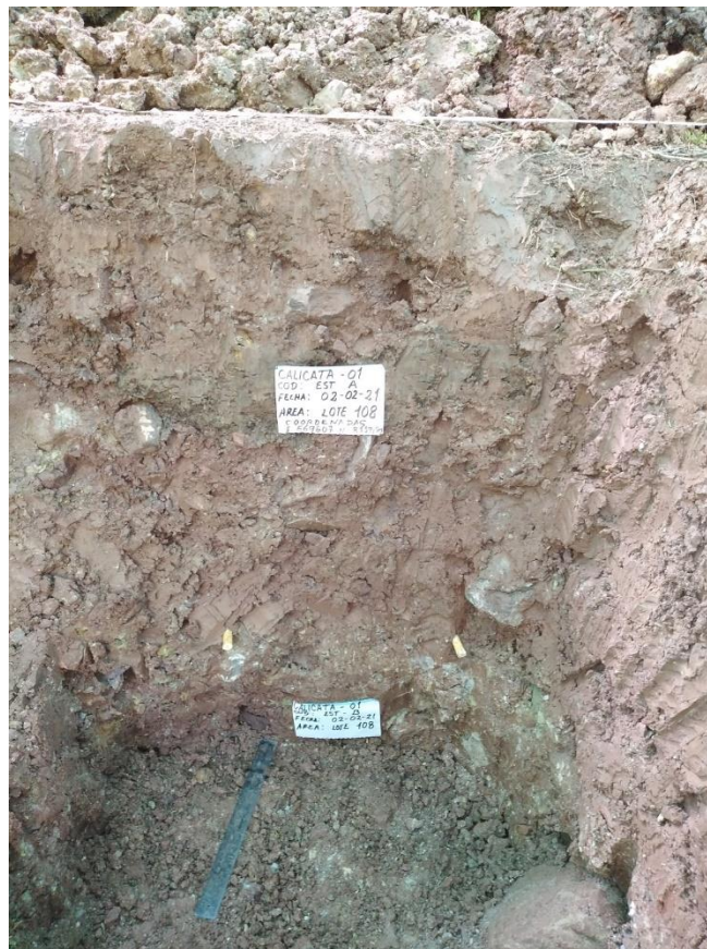
Foto 2. Calicata de Prospección de 1.00 m de profundidad.
