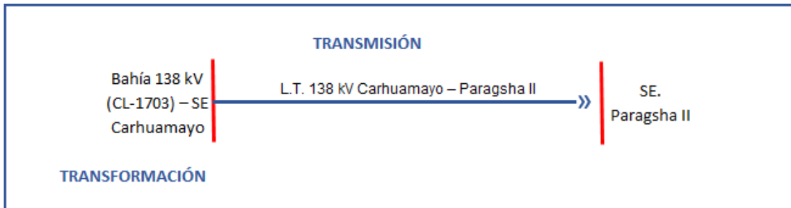
Gráfico N° 3.3 : Diagrama Unifilar Bahía 138 kV (CL-1703)
