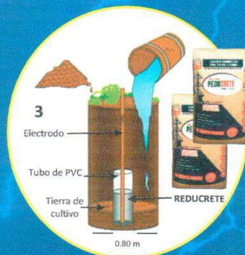
Colocar el electrodo al centro del hoyo y luego centrar el tubo de plástico y rellenar el interior del tubo de PVC con REDUCRETE®.
