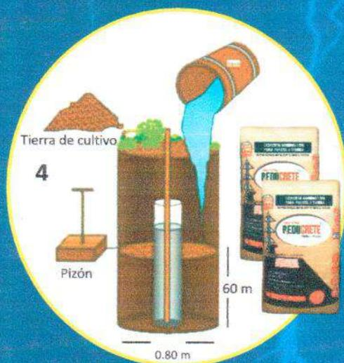
Rellenar el espacio entre las paredes del hoyo y el tubo de PVC con la tierra tratada humedeciendo y compactando bien por capas de 0.20m hasta una altura aproximada de 0.6 m.
