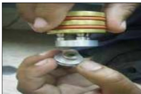
Fig. 3: Plato del impactador (parte inferior) separado de su impactador PM2,5
