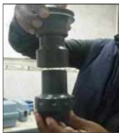
Fig. 7: Instante en que se ensambla el tubo portafiltro al adaptador (note que éste ya está acoplado al cabezal)
