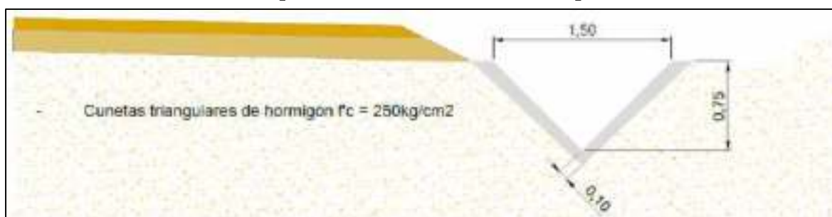
Ilustración 2.2.3 Esquema de sección de cuneta tipo 2
