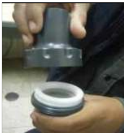
Fig. 5: Modo de colocar el cassette dentro del portafiltro (falta el filtro)
