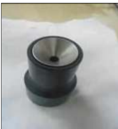
Fig. 6: Modo correcto de insertar el impactador al adaptador múltiple (los bordes de ambos deberán encontrarse al mismo nivel)
