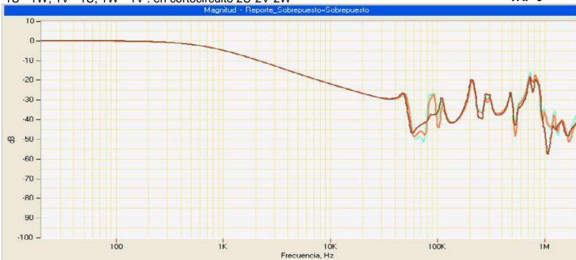
1U - 1W, 1V - 1U, 1W - 1V : en cortocircuito 2U-2V-2W
