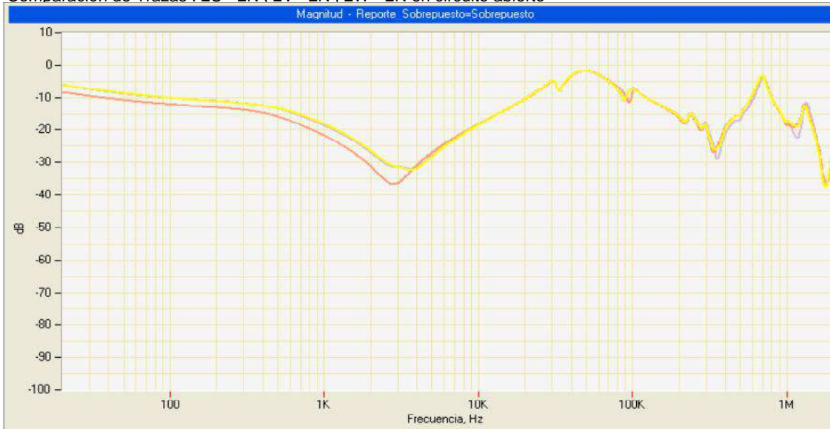
Comparación de Trazas : 2U - 2N , 2V - 2N , 2W - 2N en circuito abierto
