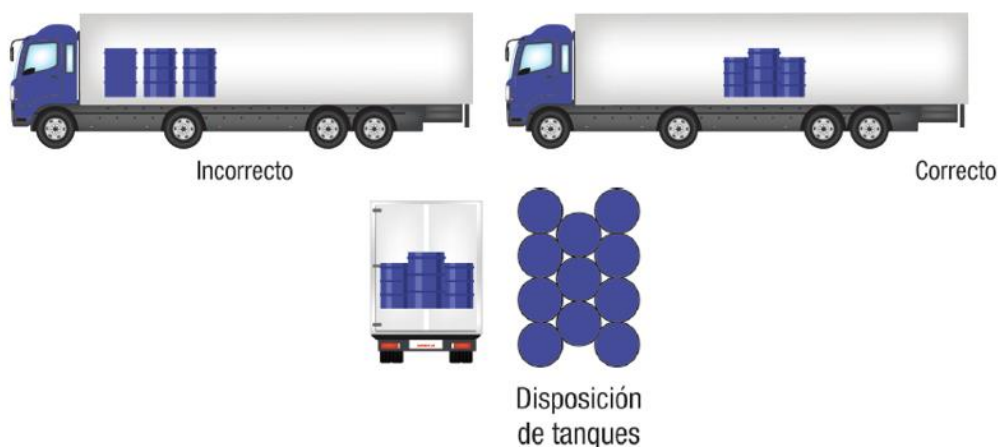
Figura N° 34: Peso y disposición de los contenedores para sólidos y líquidos contaminados con PCB
