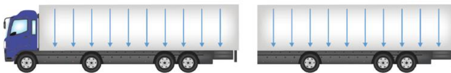
Figura N° 33: Dirección de apilamiento de los contenedores de sólidos y líquidos contaminados con PCB
