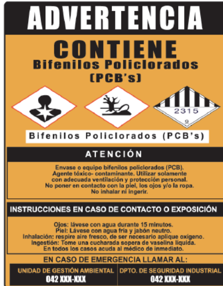
Figura N° 37: Etiquetas para equipos y contenedores que poseen aceite dieléctrico contaminado y libre de PCB
