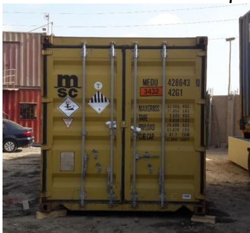
Figura N° 32: Contenedor listo con residuos PCB para su embarque
