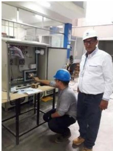
*RESIDENTE INSPECCIONANDO LOS PROTOCOLOS DE PRUEBAS DE LOS TABLEROS ELECTRICOS DE DISTRIBUCION MONOFASICA EN LABORATORIO DE I&T ELECTRIC S.A.C. EN LA CIUDAD DE LIMA*
