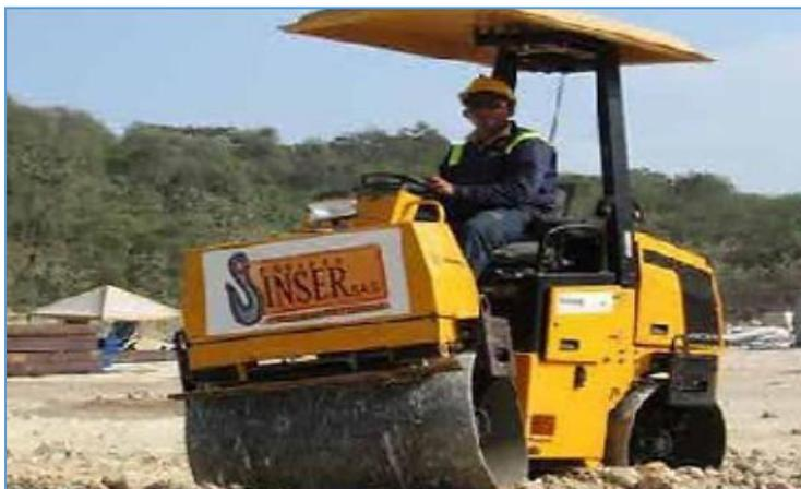
Su herramienta principal es el rodillo de gran diámetro y peso y se emplea para compactar y nivelar el material de relleno de las zanjas.
