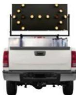
Las flechas de lámparas led instaladas en un soporte sobre camioneta, son alimentadas por el punto de salida de 12 V de la camioneta. En este caso la altura de instalación podrá ser menor a 2,10 m.
